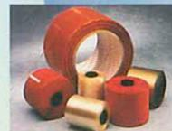
Aus MOPP-Folie hergestellte Reißbänder. Sie werden normalerweise mit druckempfindlichem Kleber beschichtet. Sie sind mindestens 1,6mm breit und haben eine maximale Länge von 50.000m auf einer einzelnen Spule. Diese Bänder können in vielen Bereichen verwendet werden. Sie werden vor allem für das Öffnen von Zigaretenschachteln, Gebäckkartons und Videokassettenpackungen benutzt.
