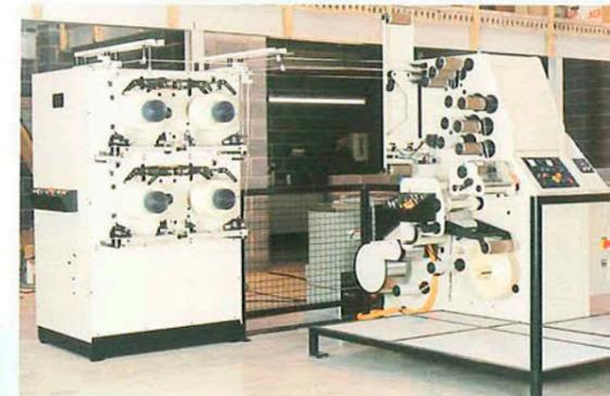
auf die Empfindlichkeit solcher extrem schmalen Bahnen die Techniken so optimiert sind, daß keine Beschädigung von Kanten an dem gespulten Material entsteht, weil sonst der nächste Arbeitsgang negativ beeinflusst wird.
